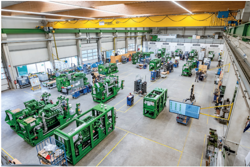
Bild 2. 2G Energy fertigt in Heek dezentrale KWK-Anlagen im Leistungsspektrum von 20 bis 4.500 kW
