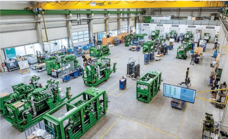
Bild 2. Bisher wurden am Standort im münsterländischen Heek KWK-Anlagen gebaut; jetzt kommt die Produktion von Wärmepumpen hinzu
