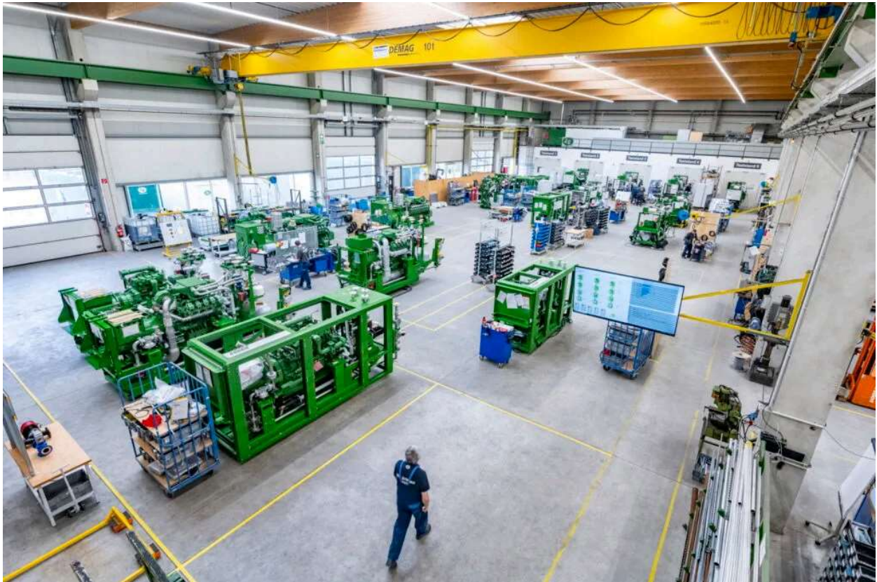
Ein Blick in die Produktionsstätte von 2G Energy am Unternehmenssitz in Heek (im Nordwesten von Nordrhein-Westfalen). Die grünen Gebilde sind Blockheizkraftwerke, die teilweise einen Rahmen („Containerisierung“) bekommen haben. Foto: 2G Energy
