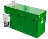
Hilfe der KWK-Anlage selbst und ist somit deutlich weniger auf den Strom vom öffentlichen Netz angewiesen. Dadurch spart der Betrieb enorme Stromkosten. Die g-box 50plus stellt eine elektrische Leistung von 50 kW und eine thermische Leistung von 104 kW bereit. Außerdem erzielt die Anlage einen elektrischen Wirkungsgrad von 34,5 % und einen thermischen Wirkungsgrad von 71,8 %. Dies ergibt wiederum einen hohen Gesamtwirkungsgrad von 106,8 %.
